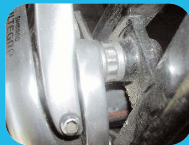
▲ Frein à étrier, écrou cranté pour l'équilibrage.
