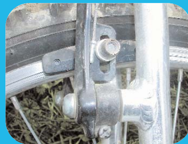
▲ Vis d'équilibrage V-Brakes à la base du frein.
