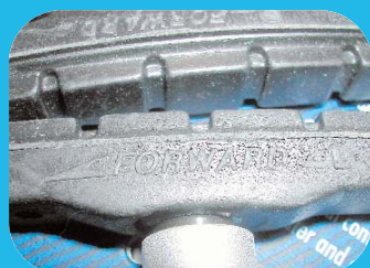
▲ Patin gauche (L) et sens de rotation de la roue.
