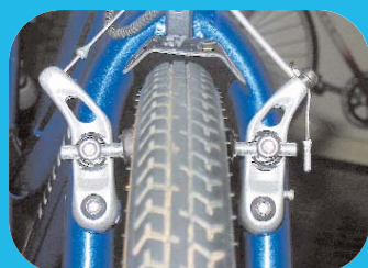
▲ Bonne position des patins sur freins Cantilever.
