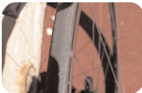
▲ Chape usée + flanc déchiré = ennuis proches.
